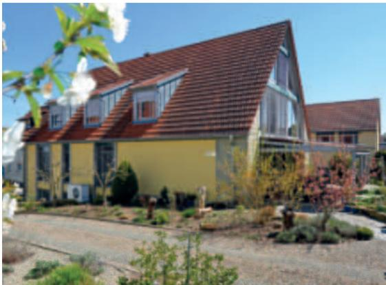
◆ Unter dem steilen Satteldach sorgen Schleppdachsgauben mit geringen Abmessungen für ausreichende Belichtung. Die Seitenflächen sollen bevorzugt mit verputzter Oberfläche, Holzschalung oder wie hier alternativ mit Stehfalzverkleidung aus Blech ausgeführt werden.
